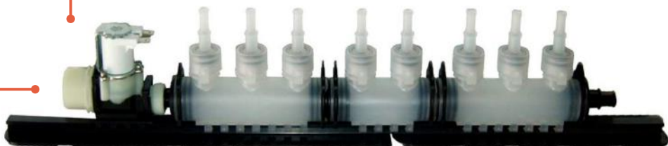
Tronchetto di flussaggio con valvole di non ritorno in ceramica e molla in hastelloy Flushing manifold equipped with ceramic non-return valves and hastelloy spring
